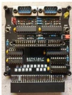
Opera dello sviluppatore norvegese Tor-Eirik Bakke Lunde, è un sostituto della ZX Interface II, progettato per essere facile ed economico da costruire. È dotata di due porte joystick tipo Atari. L'autore ha anche ideato un nuovo tipo di cartuccia, in grado di montare quattro ROM da 512 KB divise in banchi da 16 KB, per un totale di 4 MB.
