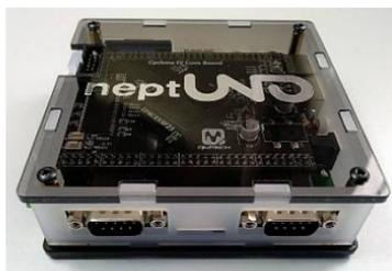
Piattaforma ideata e realizzata da Antonio Villena attorno ad una FPGA Altera Cyclone IV EP4CE55F23C8N. Ha 8 MB di RAM flash per i nuclei dei sistemi da implementare, 32 di SDRAM e 2 di SRAM.
