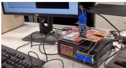
Il progetto ZX Prism 512 nasce nel 2011 per iniziativa di Jeff Braine. È un clone dello Spectrum attualmente basato su FPGA Altera Cyclone IV EP4CE15 con 512 KB di RAM. Include i firmware degli Spectrum 16/48K, 128, +2A, +3 e le ROM alternative +3e e SE BASIC 4. La CPU può essere settata a 3,5, 7, 14 e 28 MHz. Integra le funzionalità delle interfacce ZXMMC e DivMMC.
