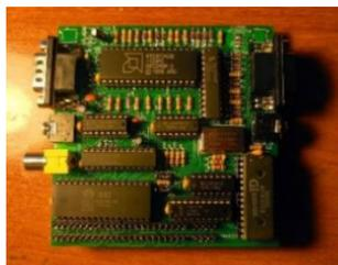
non necessitano di accedere al drive floppy, la seconda per i giochi sviluppati in ambiente TR-DOS per Pentagon ed altri cloni russi. L'interfaccia, inoltre, include un pulsante di reset e uno per generare un interrupt non mascherabile, la ROM alternativa +3e per connettere una periferica IDE, un chip sonoro AY, un ingresso audio per unificare il suono del cicalino con quello del chip sonoro, un'uscita video composito e un bus di espansione.
