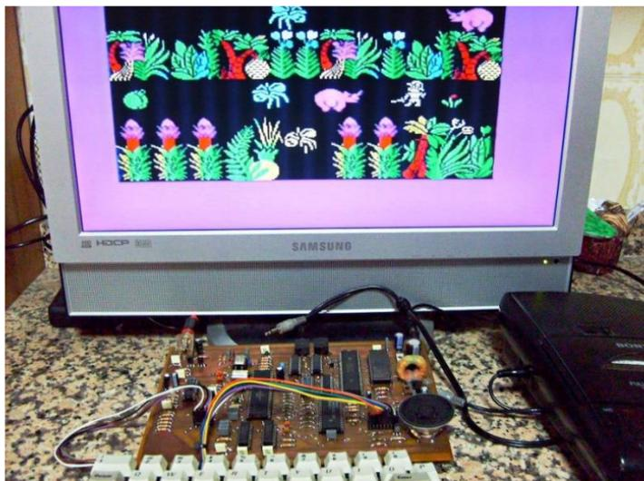
Gennaro Montedoro annuncia il suo clone dello Spectrum il primo gennaio del 2009, indicandone le caratteristiche salienti: basso consumo, solo 360 mA; due DRAM 41464 per il banco da 16 KB; una SRAM 62256 per il banco da 32 KB; solo due tensioni (+5V e +12V, quest'ultima utilizzata solo dal chip LM1889); possibilità di utilizzare l'alimentatore originale Sinclair.
