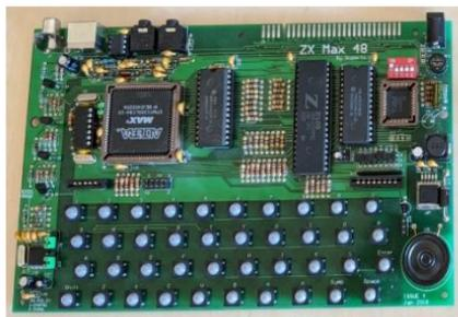
progettata per stare dentro l'involucro di uno ZX81. Oltre alle normali caratteristiche del 48K, include una EPROM a doppia capacità (2×16 KB) per montare delle immagini ROM alternative, chip sonoro AY con uscita stereo, interfaccia joystick Kempston e uscite video RGB e composito.
