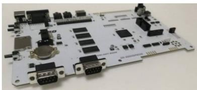
Clone dello ZX Spectrum Next “accelerato” con 2 MB di RAM, sviluppato da Manuel Fernández. È fornito come scheda madre “nuda” da montare entro l’involucro di quella macchina, o da usare con una tastiera PS/2 e un alimentatore compatibile da 5V/2A. Assieme alla personalità del Next comprende quella dello ZX-Uno.
