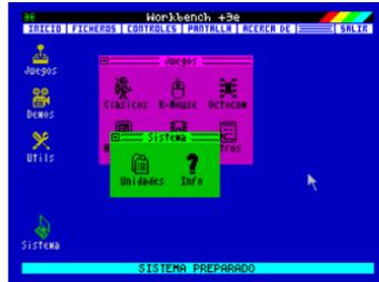
Visibilmente ispirato al Workbench dell'Amiga, si tratta di un sistema a finestre per la gestione dei dischi rigidi collegati a uno Spectrum +2A/+3 oppure a un clone ZX Uno, purché provvisti delle ROM di sistema +3e. Ne esiste pure una versione modificata per l'impiego sul MiST e derivati. Il puntatore si controlla con un mouse di tipo Kempston o un joystick Sinclair in porta 2. Oltre alla selezione e al lancio dei programmi con un
