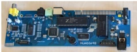
Piccolo clone dello Spectrum 48K, compatibile con l'involucro originario. È dotato di una CPU Z80 reale, il resto viene implementato tramite un chip CPLD Xilinx 95144XL. L'ultima revisione è la 3.1b del 10 dicembre 2017.
