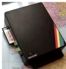
Vehmaa raccomanda di non utilizzare con l'interfaccia cavi di collegamento più lunghi di 46 cm per i dischi rigidi sia da 3" ½ che da 2" ½ (per questi ultimi è preferibile un cavo di massima lunghezza di 30 cm).
