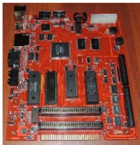
A partire dal 2006, Mikhail Tarasov ha progettato e realizzato tre cloni dello Spectrum ispirandosi al KAY-256: ZXM-777, ZXM-Phoenix e ZXM-Zephyr (nella foto), tutti sviluppati su scheda mATX con CPU TMPZ84C00-8 a 3,5 MHz e modalità “turbo” a 7 MHz. Il 777 ha 64 KB di ROM e 128 di RAM, il Phoenix 64 KB di ROM e 1024 o 2048 di RAM, lo Zephyr 512 KB di ROM e 512 o 1024 di RAM. Il suono è prodotto dal classico cicalino nonché da un chip YM2149F; lo Zephyr gli affianca uno SA1099.
